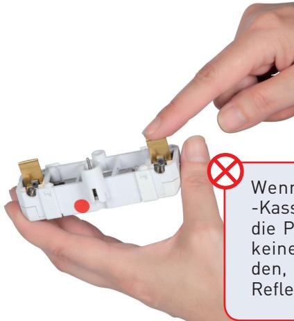
Wenn die Optic WE-0-Kassette entfernt ist, nur die Plastikteile anfassen, keinesfalls die Elektroden, die Röhre oder den Reflektor.
